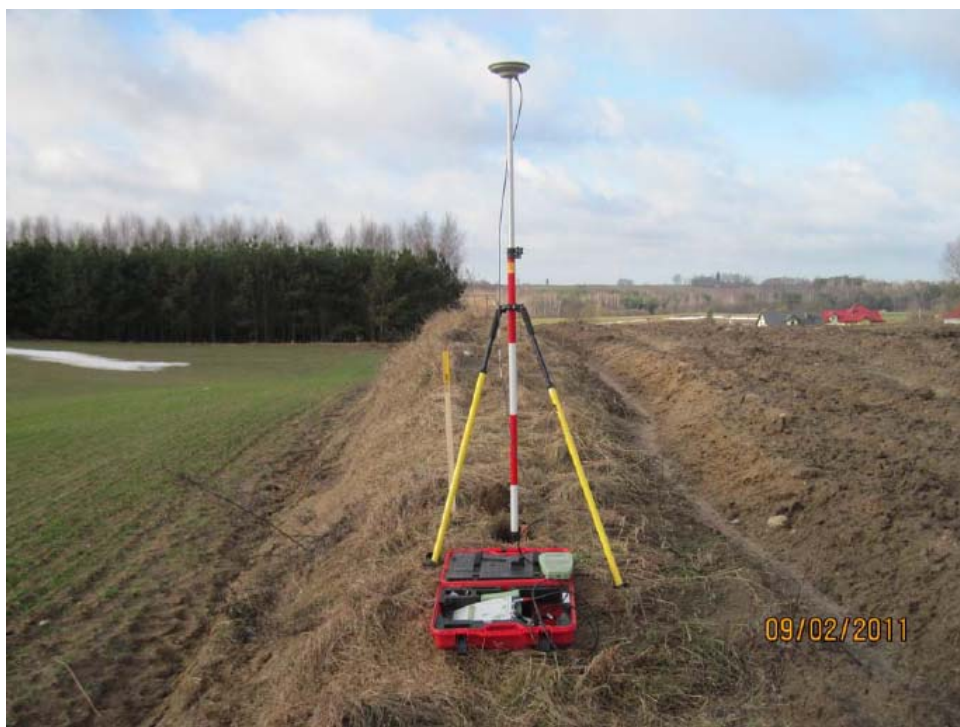
Vzhled a typické umístění geofonu na profilu - měření společnosti Basgas v Polsku v roce 2011
